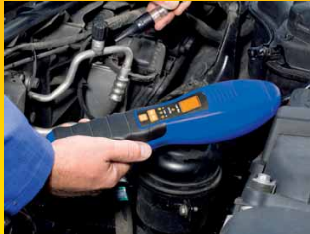
Lekzoeken met formeergas is een welkome aanvulling op bestaande lekzoekmethoden. Het uittrekkende waterstofgas wordt gedetecteerd door een speciale tracer die bijna uitsluitend op dat gas reageert. Het signaleert zelfs waterstofgas dat uit de verdampers via de ventilatie-uitstroom naar buiten treedt.
